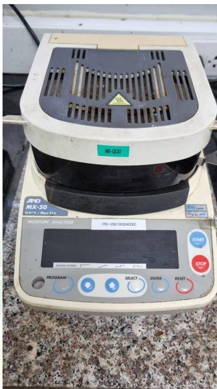
ภาพผนวกที่ 11 เครื่องวัดปริมาณความชื้น Moisture Analyzers ( MX - 50 )
