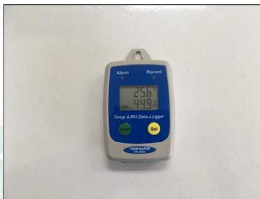
ภาพที่ 31 เครื่องวัดอุณหภูมิของอากาศ Tenmars รุ่น TM-305U
