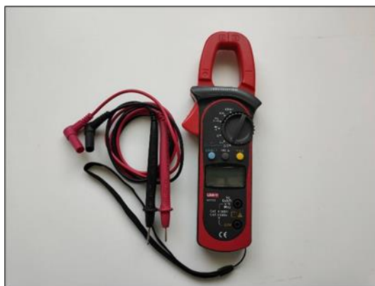
ภาพที่ 29 แคลมป์เพาเวอร์มิเตอร์รุ่น UNI-T UT204
