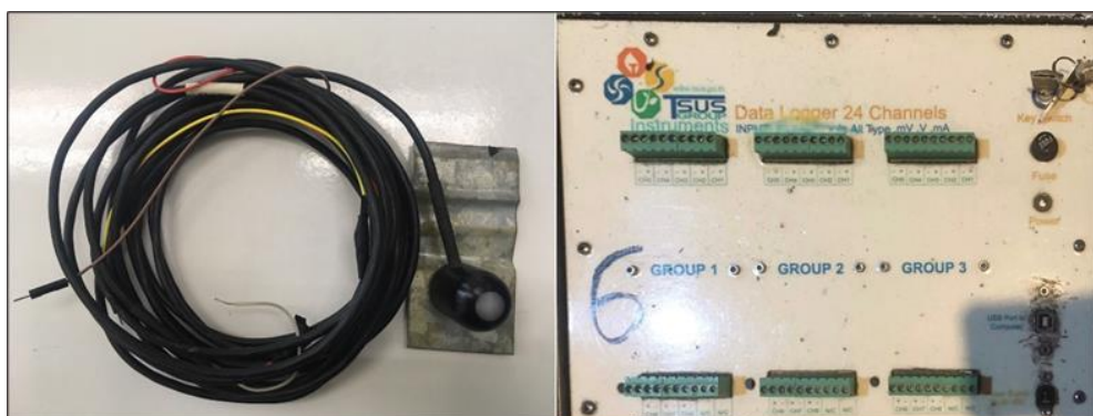
ภาพที่ 30 อุปกรณ์วัดความเข้มรังสีแสงอาทิตย์ Apogee และเครื่องบันทึกข้อมูล TSUS
