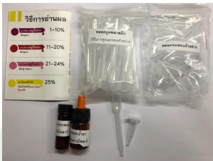
ภาพที่ 48 อุปกรณ์ชุดทดสอบสารโพลาไรซ์ในน้ำมันทอดซ้ำ ที่พัฒนาโดยกรมวิทยาศาสตร์การแพทย์
