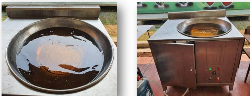
ภาพที่ 31 เตรียมน้ำมันสำหรับการทดสอบตัวอย่างของเครื่องทอดแบบของเหลวแยกชั้น
