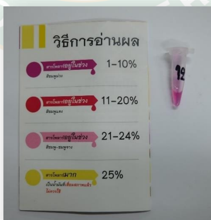
ภาพที่ 39 แสดงวิธีการอ่านค่าการทดสอบสารโพลาร์ในน้ำมันทอดซ้ำ
