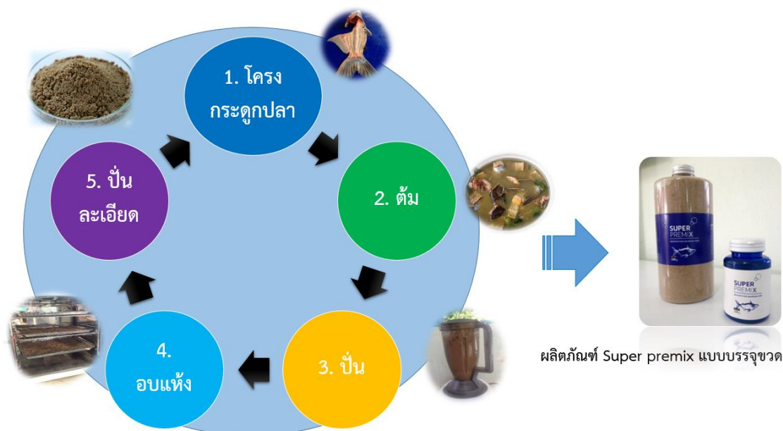
ภาพที่ 3 ขั้นตอนการผลิต Super premix ที่มา: ธนทัต และคณะ (2561)
