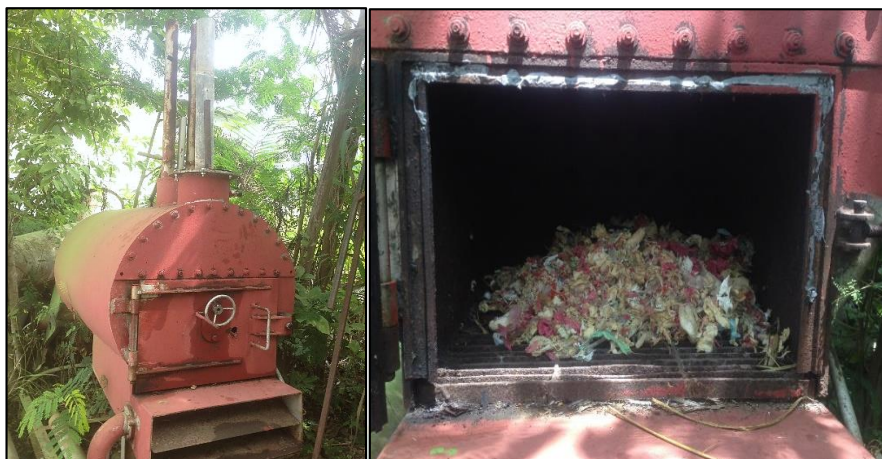
ภาพที่ 43 การทดสอบการเผาไหม้ของเชื้อเพลิงขยะติดเชื้อทางการแพทย์ที่ผ่านการอบแห้ง
