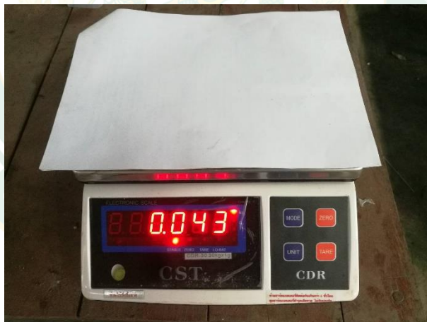
ภาพที่ 30 เครื่องชั่งน้ำหนักระบบอิเล็กทรอนิกส์ CST รุ่น CDR-30
