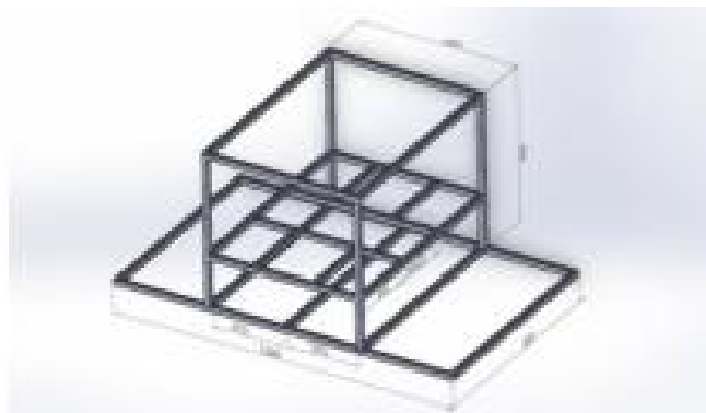
ภาพที่ 26 โครงสร้างของตัวเครื่องรองรับแผงเซลล์แสงอาทิตย์
