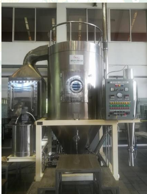
ภาพที่ 7 เครื่องอบแห้งแบบพ่นฝอย รุ่น SDE 50
