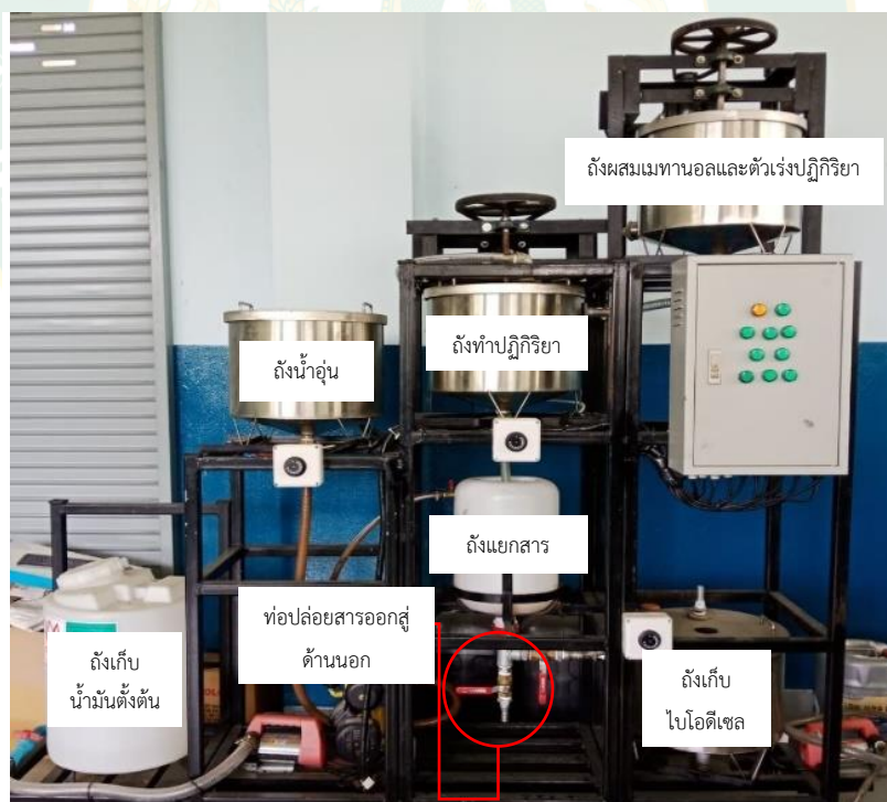
ภาพที่ 29 เครื่องต้นแบบการผลิตไบโอดีเซลที่มีการใช้ตัวเร่งปฏิกิริยาวิวิธพันธุ์
