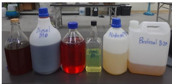
ภาพที่ 69 น้ำมันเชื้อเพลิงที่ใช้ทดสอบสมรรถนะเครื่องยนต์
