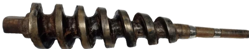
ภาพที่ 74 เกลียวอัดที่ได้จากการดัดแปลงสำหรับผลิตชีวมวลอัดแท่ง
