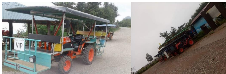
ภาพที่ 93 รถอีแต็กที่ดัดแปลงจากรถไถนั่งขับของเกษตรกรเพื่อใช้ในการบริการ ทางการท่องเที่ยวของชุมชนผาห้วย
