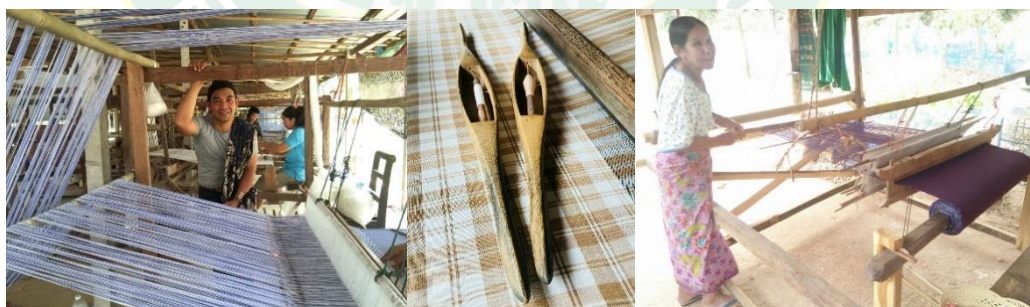
ภาพที่ 86 ลักษณะทูกหรือก่ทอผ้าและอุปกรณ์ที่ใช้ในการทอผ้า (กระสวย)
