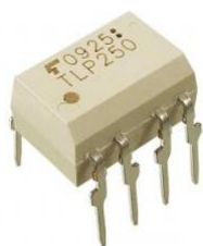
ภาพที่ 30 วงจรขับมอสเฟตแบบสำเร็จรูปในรูปแบบ IC
