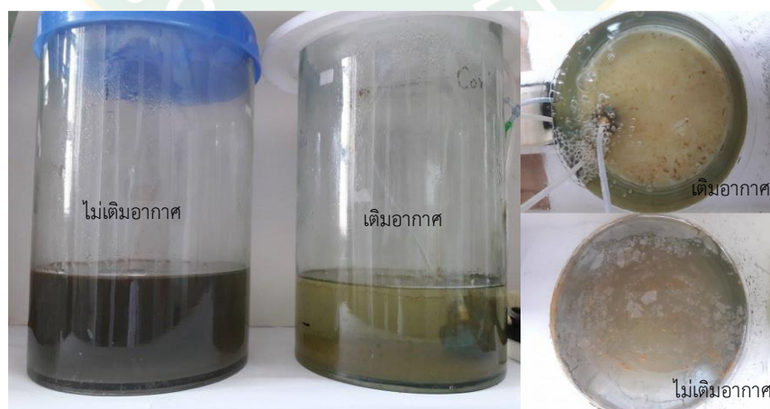
ภาพที่ 11 การทดลองการบำบัดน้ำทิ้งจากโรงงานผลิตเส้นขนมจีนแบบใช้อากาศและไม่ใช้อากาศ
