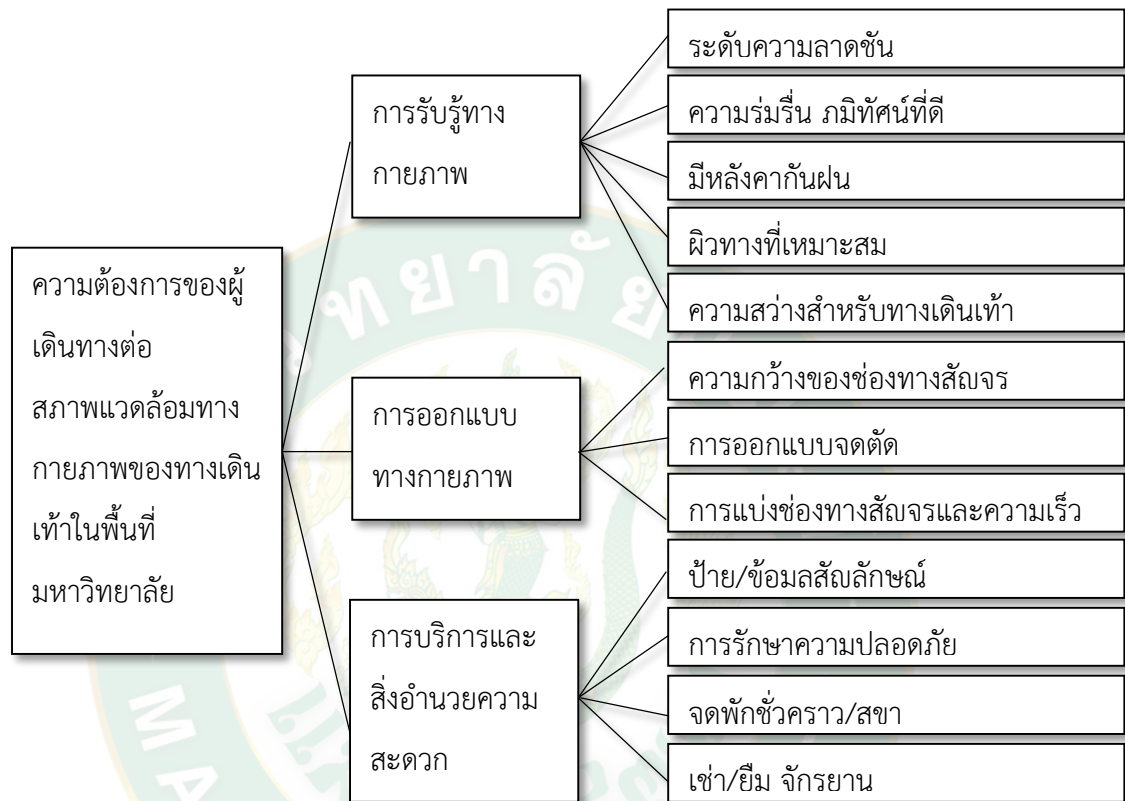
ภาพที่ 21 โครงสร้างลำดับชั้นความต้องการของผู้เดินทางต่อสภาพแวดล้อมทางกายภาพของเส้นทางเดินเท้าในพื้นที่มหาวิทยาลัย
