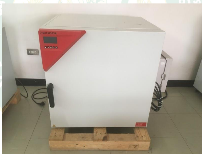
ภาพผนวกที่ 2 เครื่องอบแห้งที่ใช้ในการหาความชื้น ยี่ห้อ Binder รุ่น FD 115 ประเทศเยอรมนี
