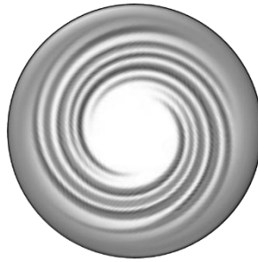
ภาพที่ 30 แผนภาพริ้วแบบก้นหอยที่เกิดขึ้นในกระบวนการเคลือบโดยการหมุนเหวี่ยง
