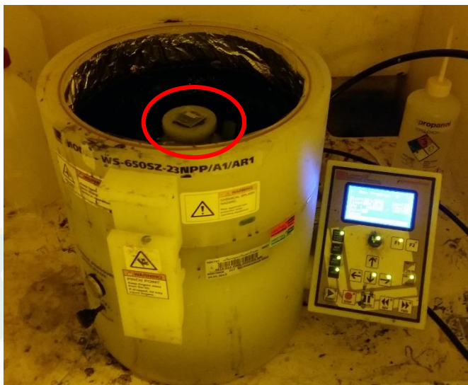
ภาพที่ 40 อิเล็กโทรดบนเครื่องเคลือบสารแบบหมุนเหวี่ยง
