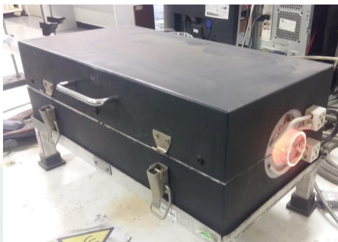
ภาพที่ 43 เตาเผาสำหรับเผาไล่ตัวประสานออกจากฟิล์มเซ็นเซอร์
