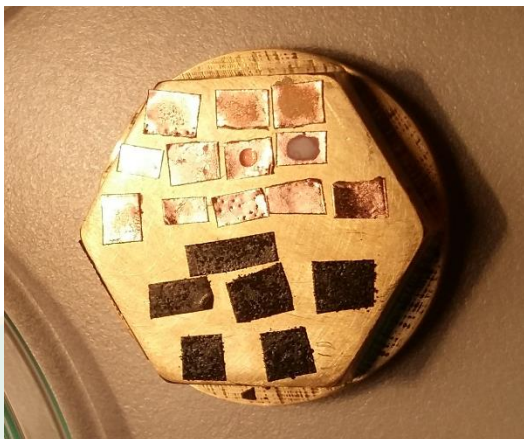
ภาพที่ 35 ตัวอย่างที่เตรียมสำหรับวิเคราะห์ด้วยเครื่อง FESEM
