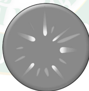
ภาพที่ 29 แผนภาพริ้วแบบดาวหางที่เกิดขึ้นในกระบวนการเคลือบโดยการหมุนเหวี่ยง
