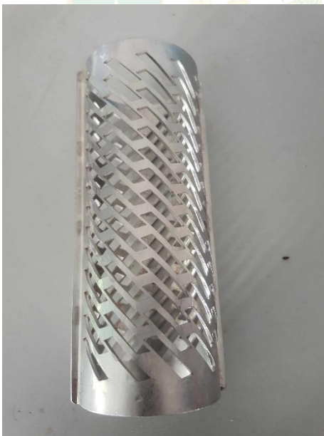
ภาพที่ ก.6 ตะแกรงรูสี่เหลี่ยมขนาด 4.5 mm
