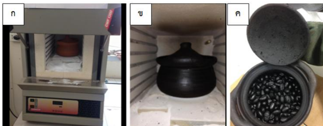
ภาพที่ 28 ขั้นตอนการเผาวัตถุดิบให้เป็นถ่าน
