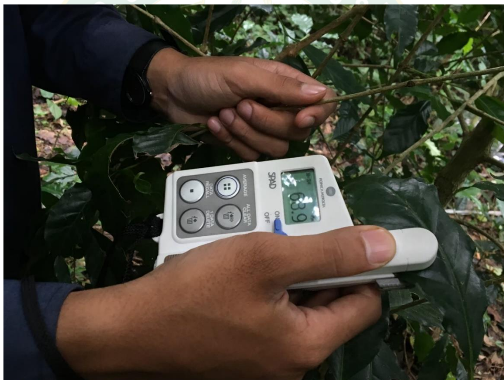
ภาพผนวกที่ 5 วัดความเขียวใบของต้นกาแฟ โดยใช้เครื่อง Minolta chlorophyll meter: SPAD-502
