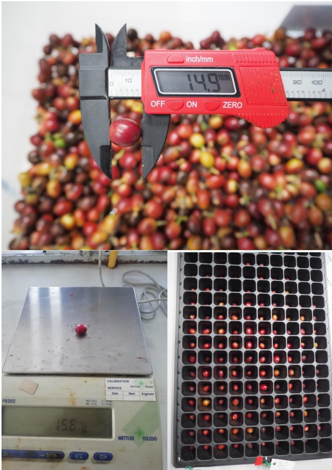
ภาพผนวกที่ 10 วัดขนาดเมล็ดกาแฟความกว้าง ความยาว ความหนาด้านประกบ และชั่งน้ำหนักเมล็ดทรายเมล็ด ตากในภาชนะ มีซี้อและรหัสกำกับ เพื่อป้องกันไม่ให้ผสมรวมกันของเมล็ดกาแฟ
