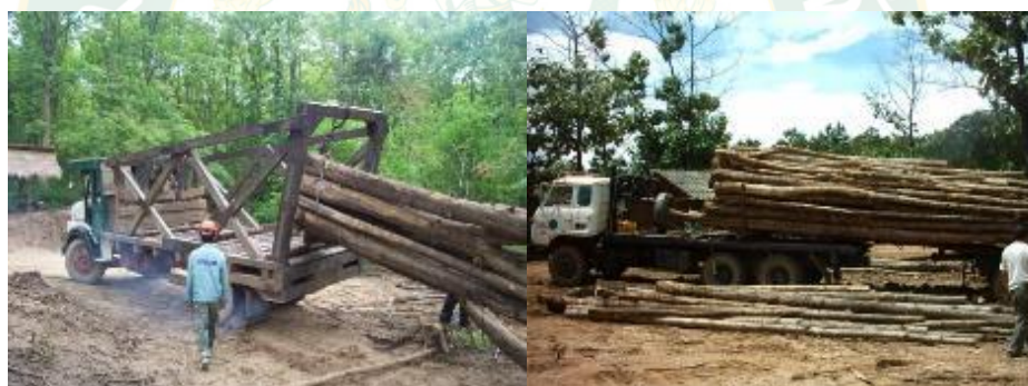
ภาพที่ 28 การชักลากไม้ที่มีความยาวมาก ด้วยรถจอบหนึ่งหรือรถสาลี
