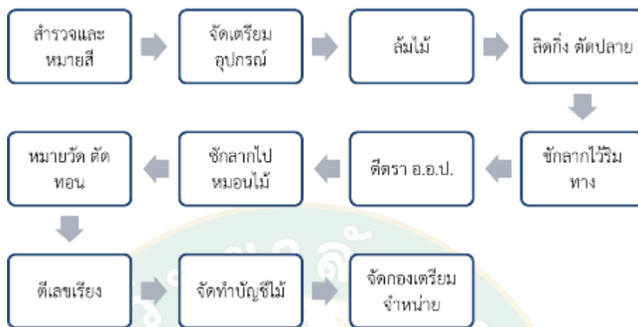
ภาพที่ 37 ขั้นตอนการทำไม้สักท่อนสวนป่า
