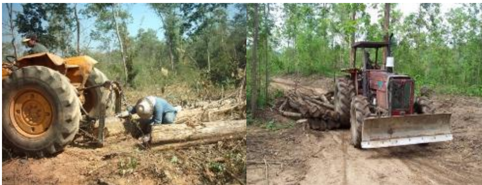
ภาพที่ 27 การชักลากไม้ด้วยรถแทรกเตอร์ล้อยาง
