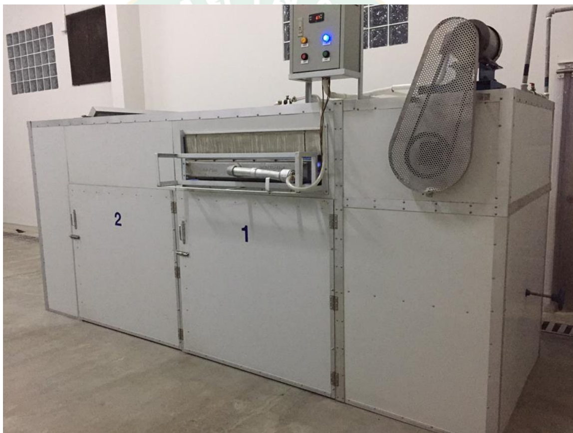
ภาพที่ 7 เครื่องอบแห้งแบบต่อเนื่องชนิดอุโมงค์ด้วยก๊าซอินฟราเรด - ลมร้อน แบบใช้อุณหภูมิสูง หมายเลขตู้ 1 และ 2
