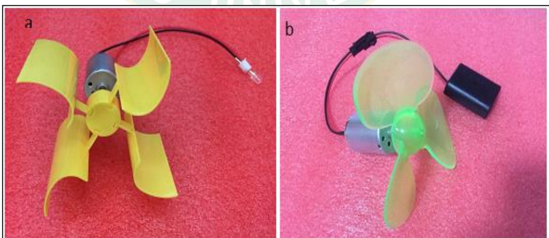
ภาพที่ 74 กังหันลมที่ใช้ในการทดสอบ a) กังหันลมแนวแกนตั้ง b) กังหันลมแนวแกนนอน
