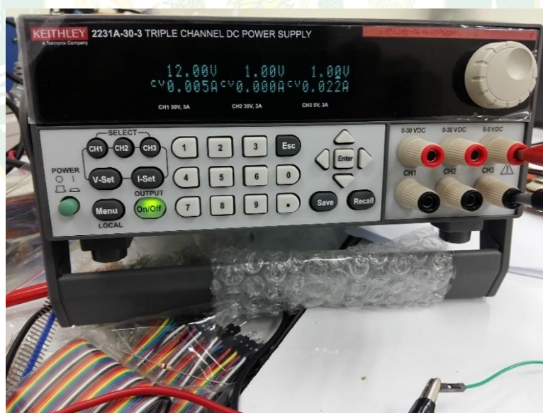
ภาพที่ 45 เครื่องจ่ายไฟฟ้ากระแสตรง (DC power supply) ยี่ห้อ KEITHLEY รุ่น 2231A-30-3
