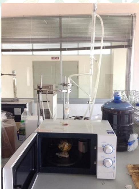
ภาพที่ 12 เครื่องกลั่นน้ำมันหอมระเหยแบบไมโครเวฟร่วม
