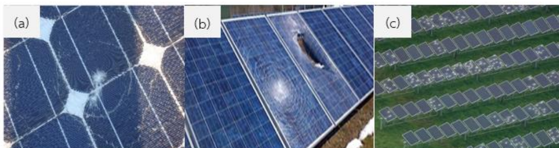
ภาพที่ 2 ความเสียหายของแผงเซลล์แสงอาทิตย์กลุ่มที่หนึ่ง
