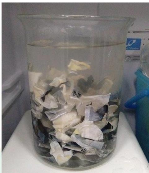
ภาพผนวก ค 16 เซ็นสารละลายกรดอะซิติก 0.5 โมล กวนเป็นเวลา 72 ชั่วโมง อุณหภูมิ 4 °C
