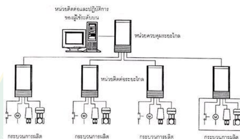
ภาพที่ 19 การติดตั้งสกาตาสำหรับตรวจสอบเก็บรวบรวมข้อมูลและบริหารระบบควบคุม
