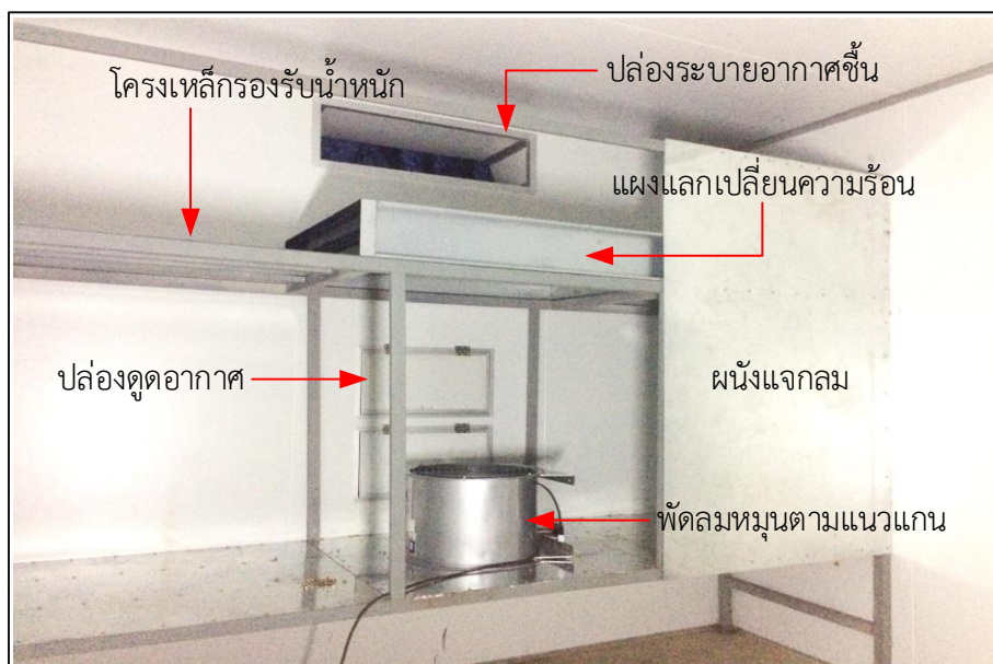
ภาพที่ 27 ส่วนประกอบด้านในของห้องอบแห้งแบบรวมศูนย์
