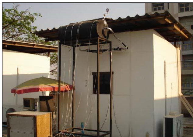
ภาพที่ 17 ระบบทำน้ำเย็นภาคกลางคืนเพื่อลดภาระความเย็นเครื่องปรับอากาศ
