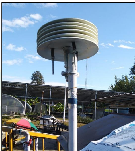
ภาพที่ 33 เครื่องตรวจวัดอุณหภูมิสิ่งแวดล้อม
