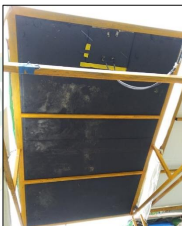
ภาพที่ 20 กล่องน้ำระบายความร้อนติดตั้งใต้โมดูลเซลล์แสงอาทิตย์
