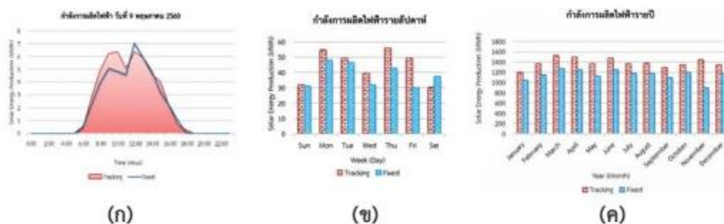
รูปที่ 3 กำลังการผลิตไฟฟ้าโรงไฟฟ้าพลังงานแสงอาทิตย์แบบระบบคงที่และแบบระบบติดตามดวงอาทิตย์ (ก) รายวัน (ข) รายสัปดาห์ และ (ค) รายปี
