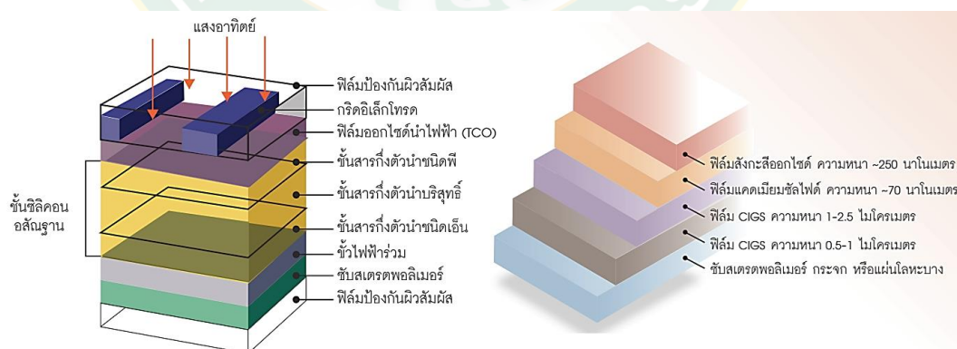
ภาพที่ 16 โครงสร้างของเซลล์แสงอาทิตย์ชนิดฟิล์มบางของธาตุซิลิคอนอสัณฐานและโลหะผสม CIGS
