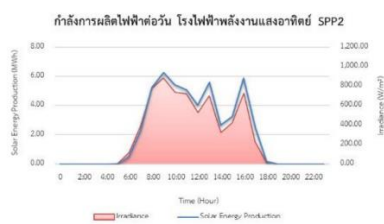
รูปที่ 8 ความสัมพันธ์ระหว่างกำลังการผลิตไฟฟ้าและค่ารังสีอาทิตย์เทียบกับเวลา
