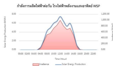
รูปที่ 7 ความสัมพันธ์ระหว่างกำลังการผลิตไฟฟ้าและค่ารังสีอาทิตย์เทียบกับเวลา
