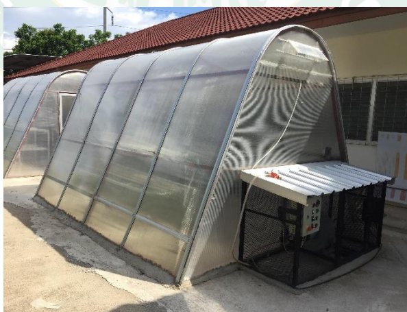
ภาพที่ 16 โดมอบแห้งที่ใช้พลังงานแสงอาทิตย์และพลังงานในรูปแบบอื่น
