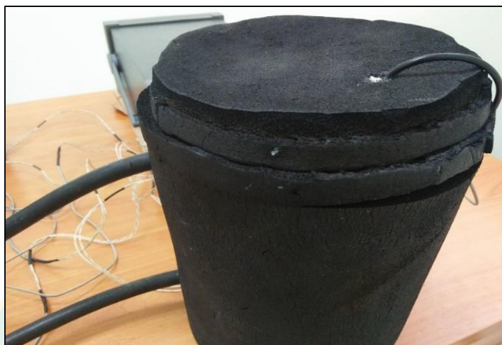
ภาพที่ 36 ถังเก็บน้ำเย็น ขนาด 5 ลิตร
