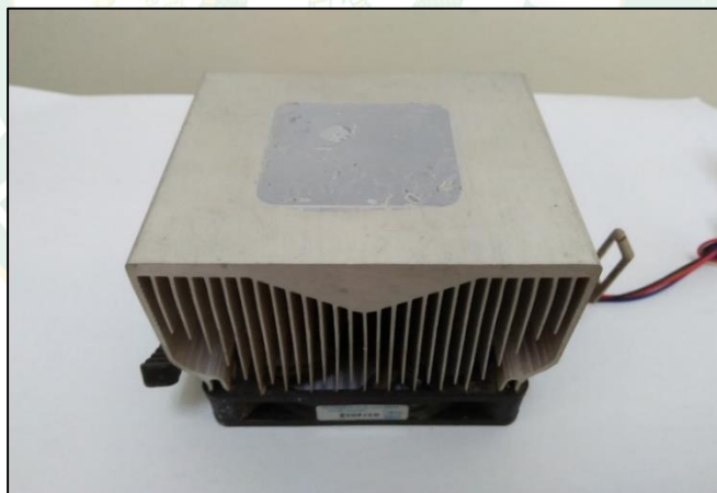
ภาพที่ 42 ฮีทซิงค์ที่ใช้ระบายความร้อน
