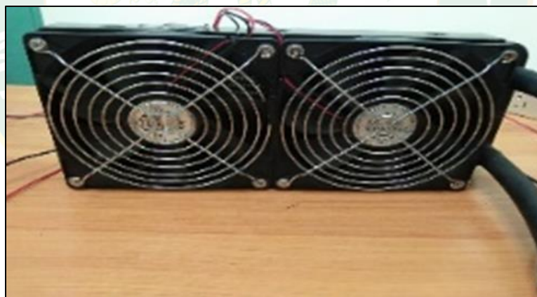
ภาพที่ 68 หม้อน้ำระบายความร้อน
