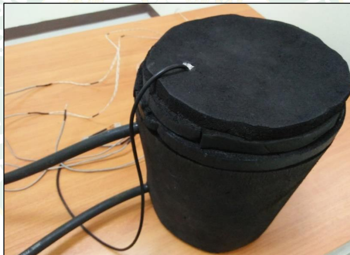
ภาพที่ 70 ถังเก็บน้ำขนาด 2 ลิตร
