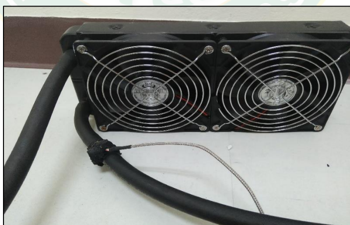
ภาพที่ 35 หม้อน้ำระบายความร้อน
