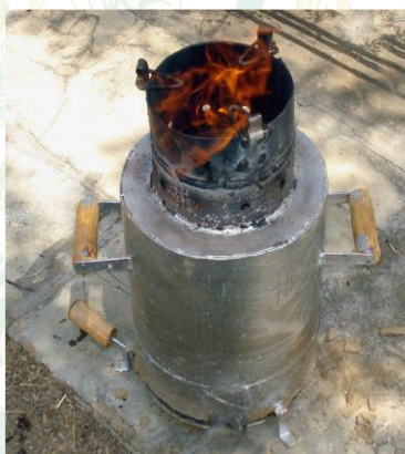
ภาพที่ 32 เตาชีวมวลแบบใช้ฟืน ขนาด 5 \text{ kW}
