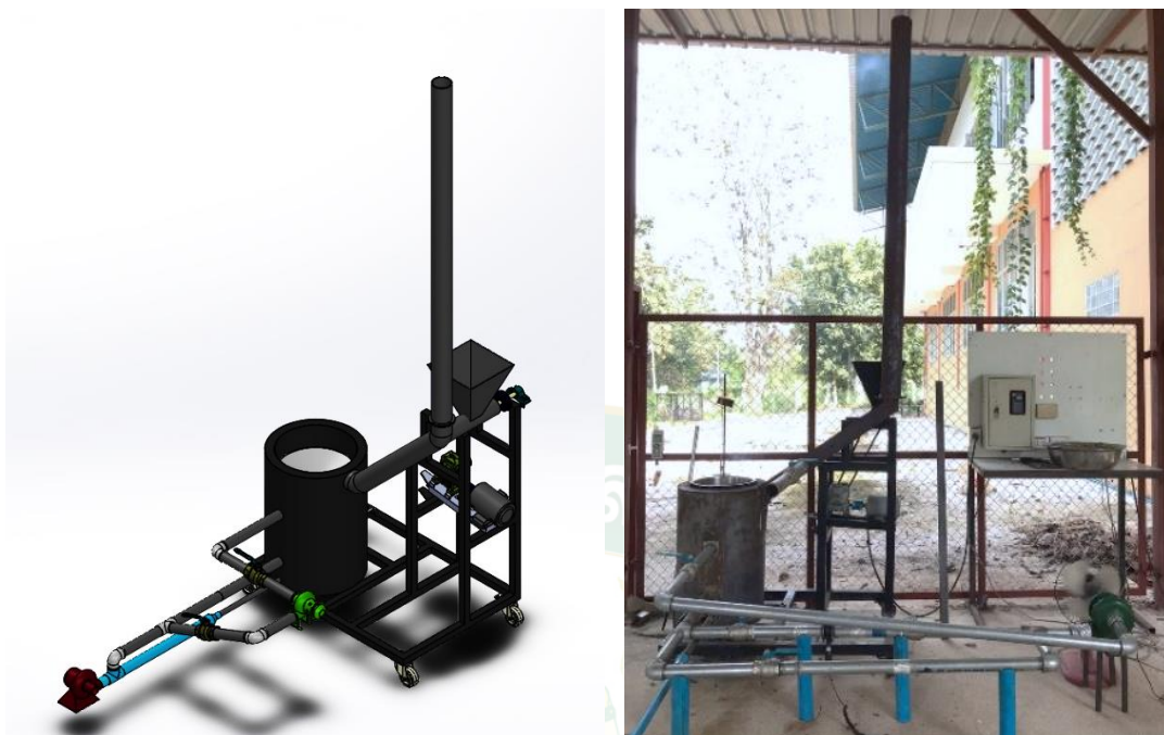
ภาพที่ 56 การประกอบและติดตั้งเตาชีวมวลประสิทธิภาพสูงสำหรับเชื้อเพลิงอัดเม็ด
