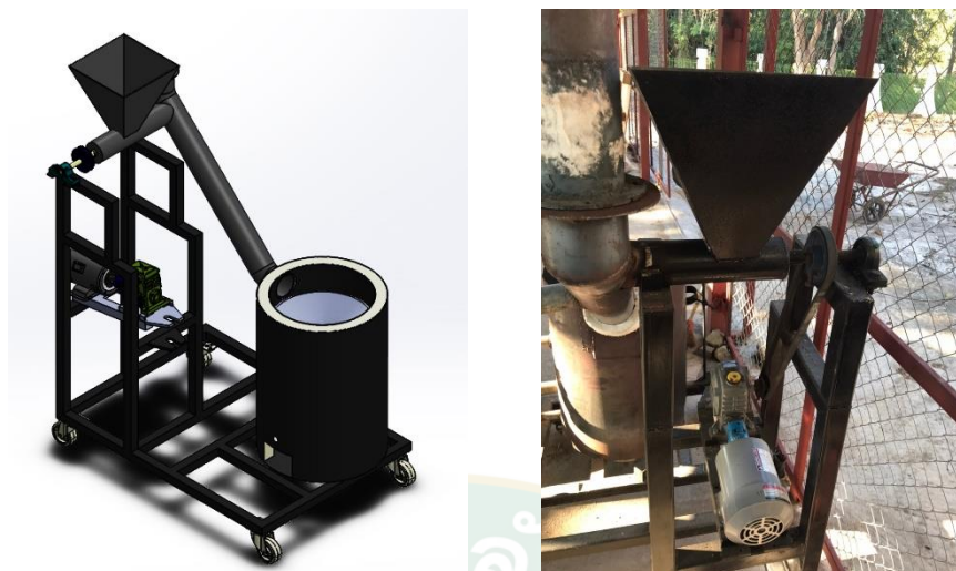
ภาพที่ 54 ระบบป้อนเชื้อเพลิงอย่างต่อเนื่องด้วยสกรูลำเลียงของเตาชีวมวล
