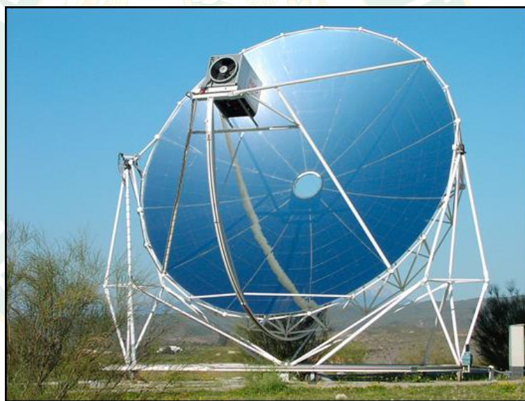
ภาพที่ 10 ระบบงานพาราโบลา (Parabolic Dish)
