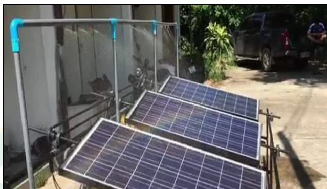
ภาพที่ 34 โครงสร้างระบบติดตามดวงอาทิตย์และระบบระบายความร้อนด้วยน้ำ
