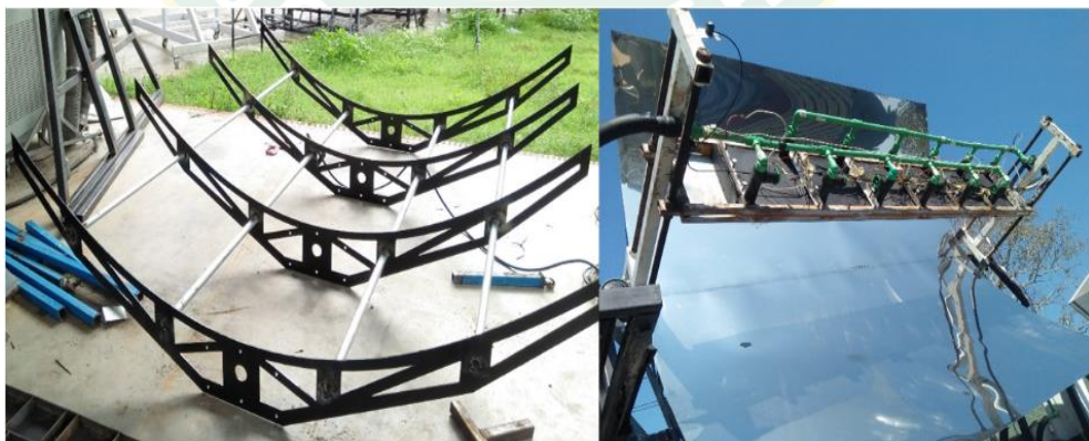
ภาพที่ 39 รางรวมแสงพาราโบลาที่สร้างขึ้นจริง
