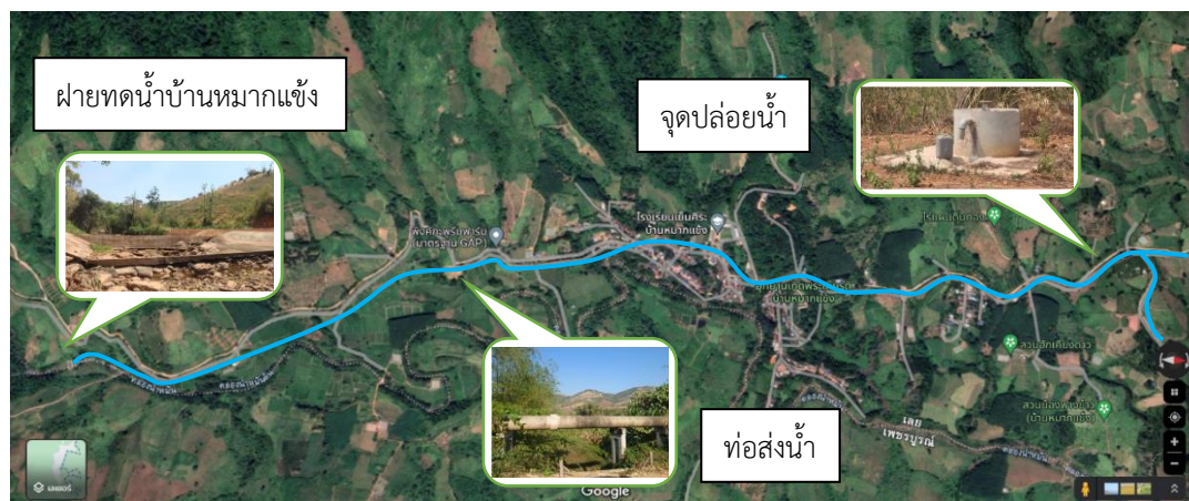
ภาพที่ 15 แสดงแผนผังระบบชลประทานบ้านหมากแข้ง
