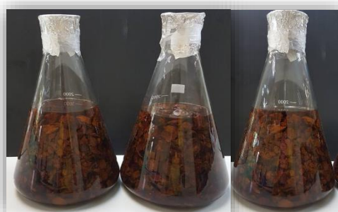
ภาพที่ 11 ภาพการสกัดสารสกัดหยาบ crude extract เปลือกมังคุด ด้วยเอทานอลเข้มข้นร้อยละ 95
