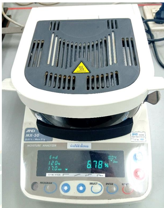
ภาพผนวกที่ 9 การวิเคราะห์ปริมาณความชื้น
