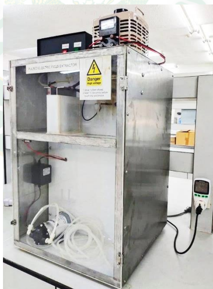
ภาพผนวกที่ 12 การวัดพลังงานไฟฟ้าเพื่อนำไปวิเคราะห์ความสิ้นเปลืองพลังงานจำเพาะ
