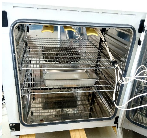
ภาพผนวกที่ 3 การทำแห้งด้วยตู้อบลมร้อน
