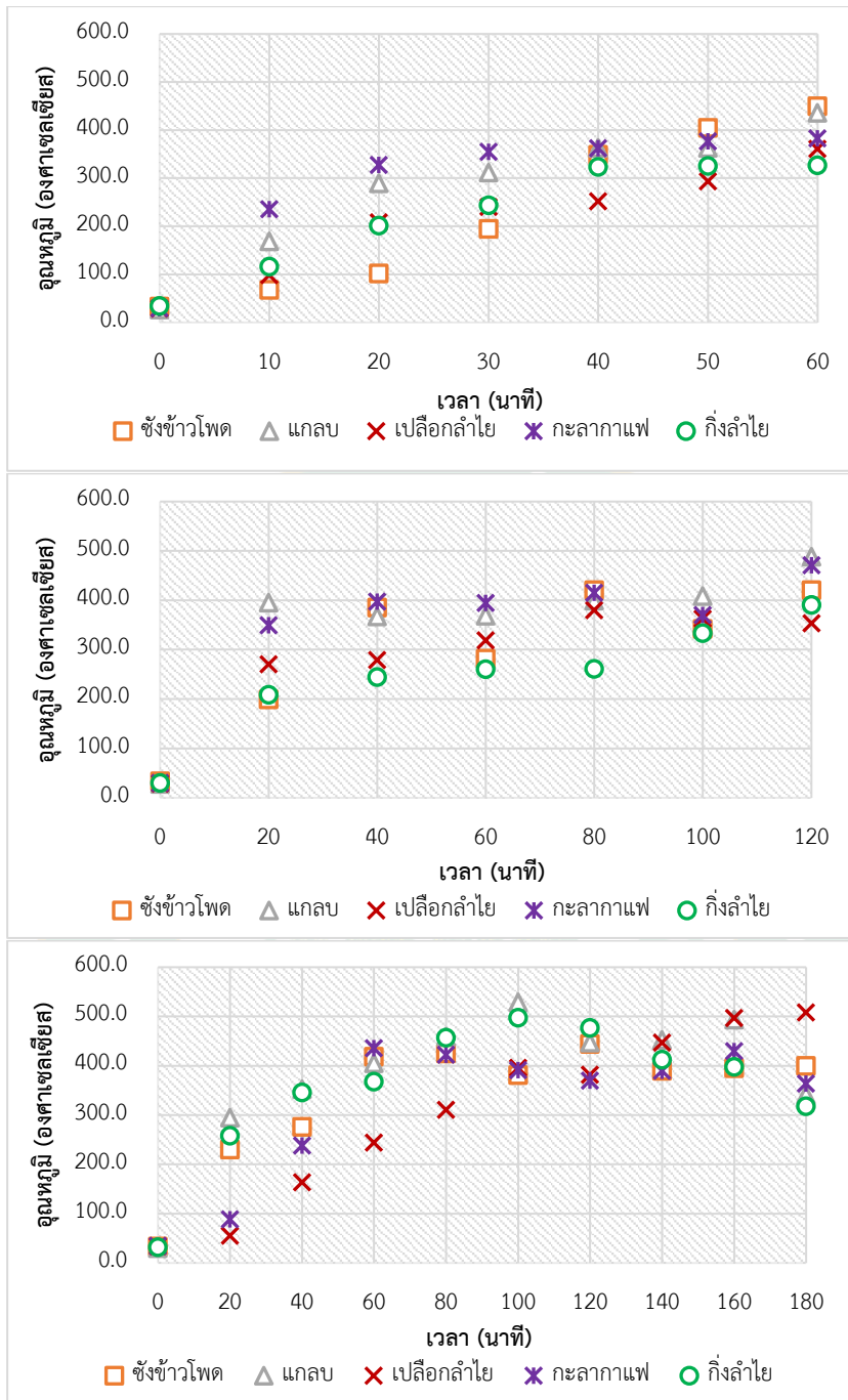
ภาพที่ 15 แผนภูมิแสดงการกระจายอุณหภูมิในกระบวนการผลิตถ่านชีวภาพเตาถ่านชีวภาพขนาด 200 ลิตร จากเศษวัสดุเกษตร เวลา 1 ชั่วโมง (a) เวลา 2 ชั่วโมง (b) และเวลา 3 ชั่วโมง (c)
