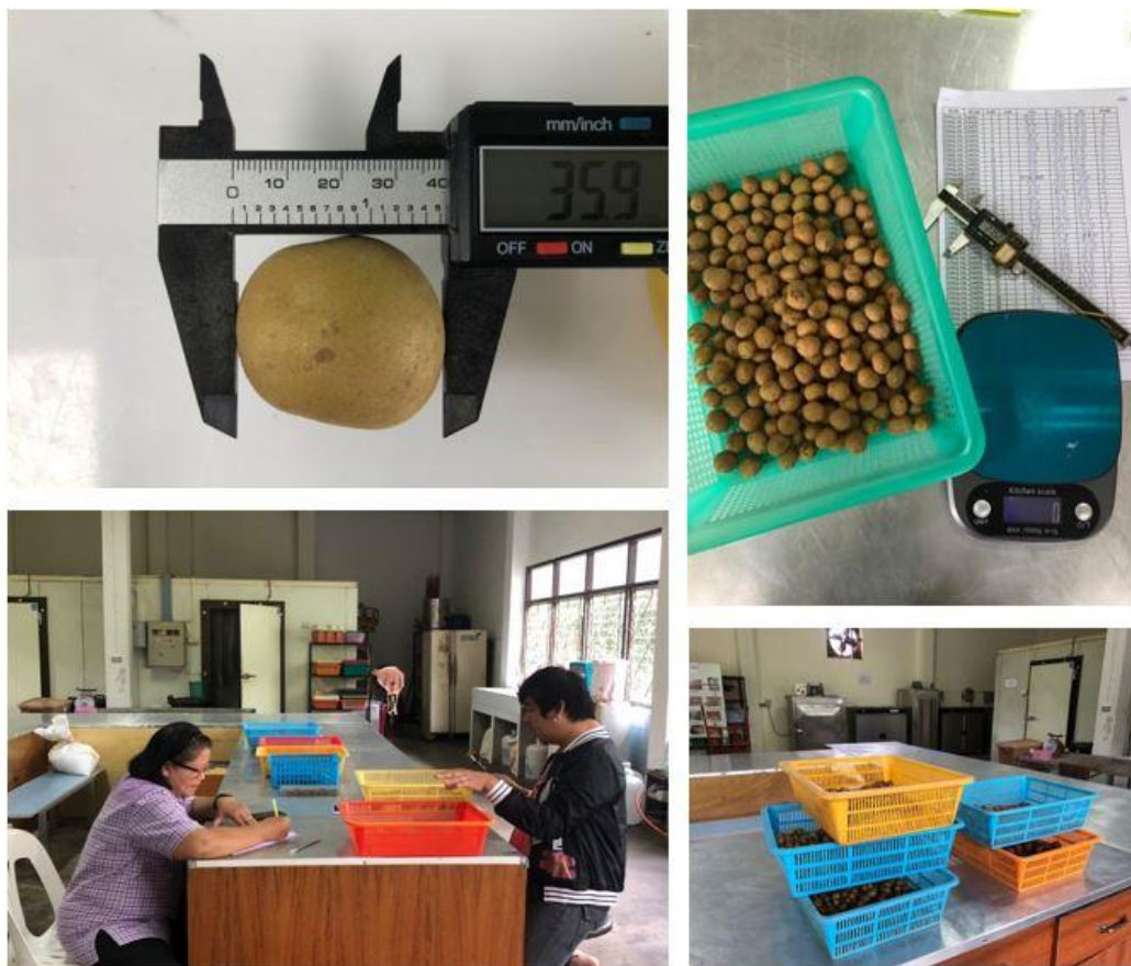
ภาพที่ 18 การวัดขนาดความกว้าง ความยาว ความหนา และชั่งน้ำหนัก แต่ละหัวของหัวพันธุ์มันฝรั่ง
