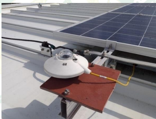
ภาพที่ 49 เครื่องมือวัดรังสีรวมของความเข้มแสงอาทิตย์ ไพรานอมิเตอร์ (PYRANOMETER)
