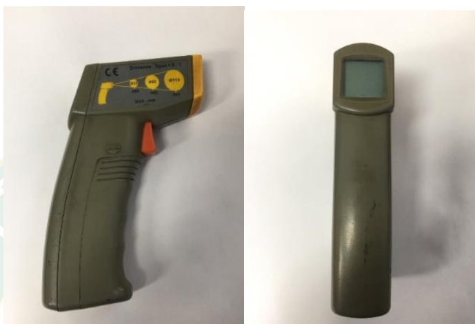
ภาพที่ 36 เครื่องวัดอุณหภูมิแบบอินฟราเรด
