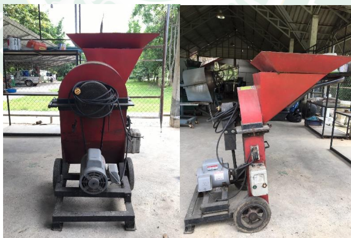
ภาพที่ 17 เครื่องบดย่อยชีวมวลแบบหยาบและชีวมวลที่บดย่อย
