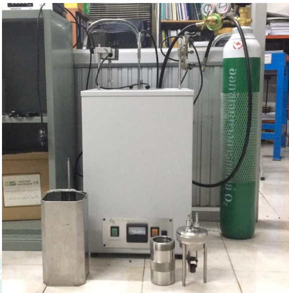
ภาพที่ 33 เครื่องวิเคราะห์ค่าความร้อนชีวมวล
