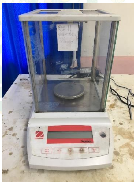
ภาพที่ 35 เครื่องชั่งดิจิทัล Pioneer ทศนิยม 4 ตำแหน่ง
