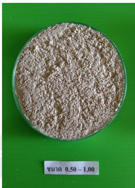
ภาพที่ 3 เปลือกหอยเชอรี่บดขนาด 0.50-1.00 มิลลิเมตร
