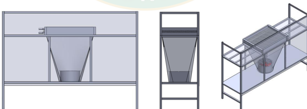
ภาพที่ 79 แบบจำลองของห้องอบแห้งแบบรวมศูนย์แบบมีท่อส่งอากาศ
