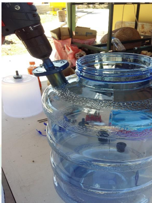
ภาพที่ ข-1 สร้างถังหมักขนาด 19 L สำหรับการทดลองในระดับห้องปฏิบัติการ
