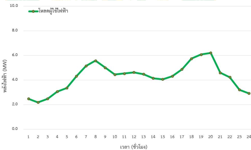
ภาพผนวกที่ 9 ลักษณะโหลดผู้ใช้ไฟฟ้าของระบบจำหน่ายไฟฟ้า กรณีโหลดมีค่าลดลง 20% จากกรณีฐาน
