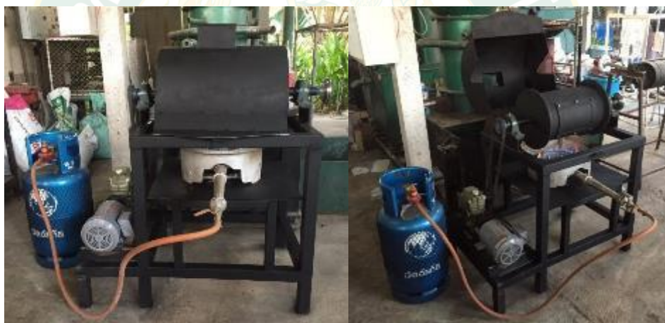
ภาพที่ 23 เครื่องผลิตเชื้อเพลิงทอร์รีไฟต์ระดับ Pilot scale
