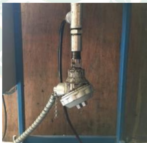
ภาพที่ 15 ชุดวัดอุณหภูมิ (thermocouple)
