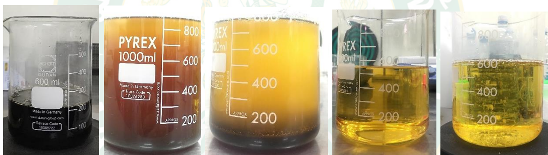
ภาพที่ 4.4 การผลิตน้ำมันโดยใช้ตัวเร่งปฏิกิริยาแบบสองขั้นตอน ในกระบวนการทรานส์เอสเทอร์ฟิเคชัน
