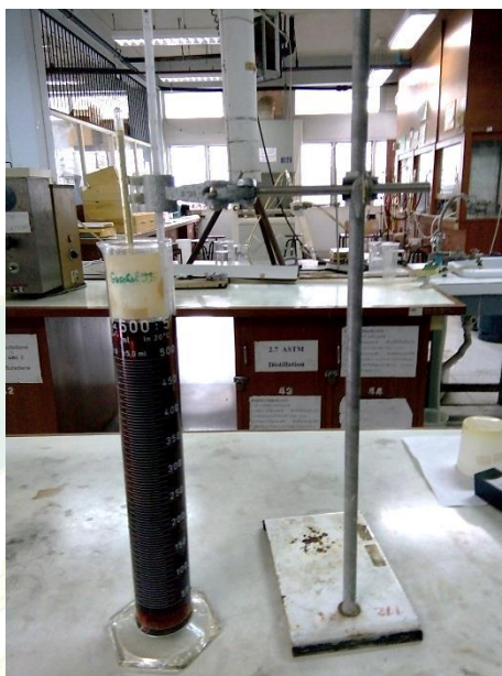
ภาพที่ 3.2 ชุดไฮโดรมิเตอร์วัด API ที่ใช้ทดสอบจริง ที่มา : (Applied, 2559)
