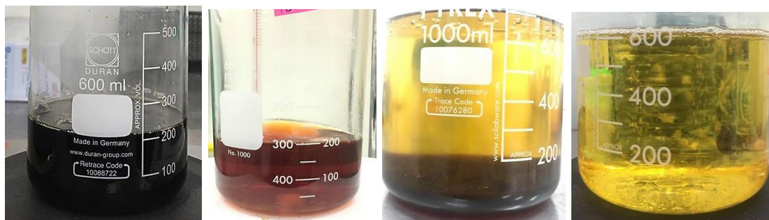
ภาพที่ 4.5 การผลิตน้ำมันโดยใช้ตัวเร่งปฏิกิริยาแบบสองขั้นตอน ในกระบวนการ ทรานส์เอสเทอร์ฟิเคชัน
