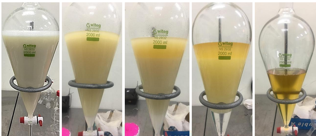
ภาพที่ 3.12 ขั้นตอนการล้างไบโอดีเซลด้วยน้ำอุ่น
