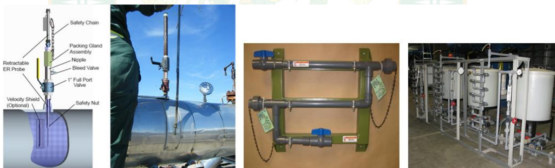
ภาพที่ 3.11 โลหะคูปองทดสอบการกัดกร่อน ไปติดตั้งในระบบการใช้งานจริง ที่มา : (รจจิภรณ์, 2559)
