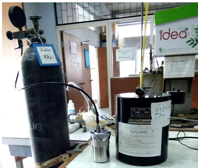
ภาพที่ 3.8 บอมบ์แคลอริมิเตอร์ (Bomb calorimeter) ที่ใช้ทดสอบจริง
